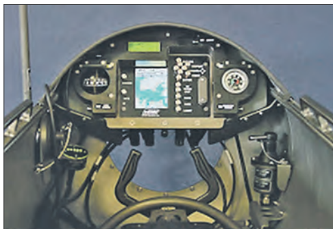
Приборные панели и органы управления буксировщиками: слева – «Дпд-ТЕС2» (слева); справа – «Дпд-ХТ» (с ГАС на борту, в этом варианте отсутствует круглый иллюминатор и установлен новый многофункциональный дисплей)
