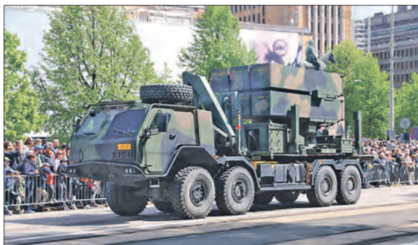
Норвежский зенитный ракетный комплекс «Насамс», предназначенный для борьбы с маневрирующими аэродинамическими целями на малых и средних высотах
