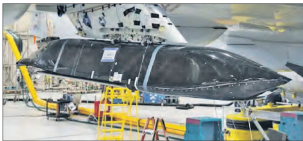
КРВБ AGM-158С «Лрасм» на внешней подвеске БПС Р-8А «Посейдон» (вверху) и перспективная гиперзвуковая КРВБ «Хакм» (внизу)
