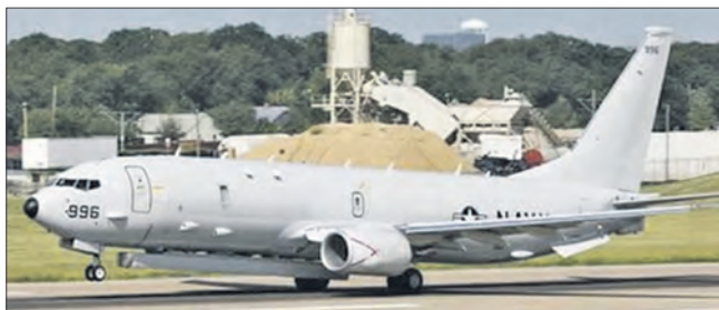
РЛС с АФАР AN/APS-154 AAS под фюзеляжем БПС Р-8А «Посейдон»
