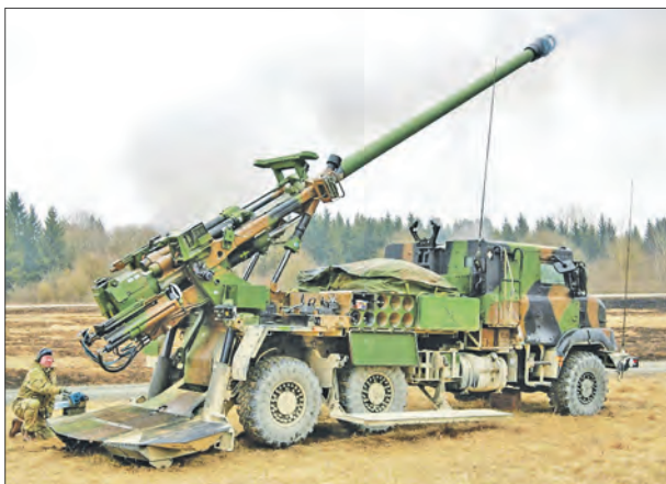
155-мм САУ «Сезар» («Цезарь»), производимая французской фирмой «Некстер». Имеет полуавтоматическую систему подачи снарядов. Максимальная дальность стрельбы осколочно-фугасным снарядом – 41 км, снарядом V-LAP – более 55 км. САУ совместима с дальнебойным снарядом M2005 V-LAP с дальностью стрельбы 54 км
