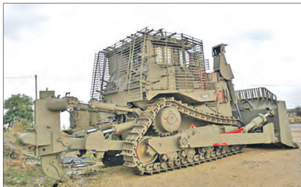
Бронированный бульдозер «Катерпиллер» D9R со съёмным бульдозерным отвалом и задним рыхлителем грунта
