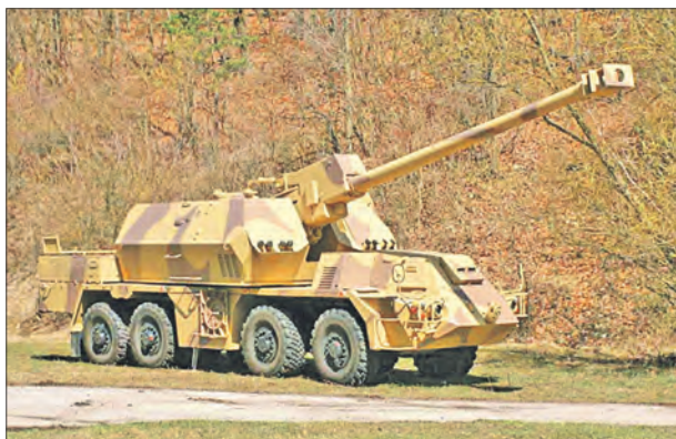
155-мм САУ «Зузана» – самоходная гаубица с длиной ствола 52 калибра и максимальной дальностью стрельбы 41 км, масса 32 т, экипаж четыре человека. Автоматическая система заряжания позволяет производить 6 выстр./мин
