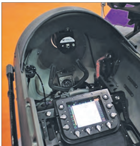
Приборные панели и органы управления буксировщиками: слева – «Дпд-ТЕС2» (слева); справа – «Дпд-ХТ» (с ГАС на борту, в этом варианте отсутствует круглый иллюминатор и установлен новый многофункциональный дисплей)
