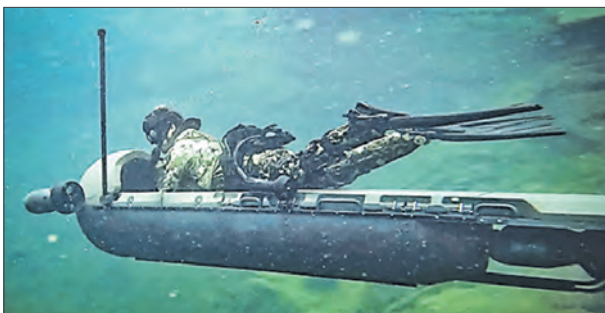
Подводный буксировщик «Кракен» с дополнительными модулями аккумуляторных батарей
