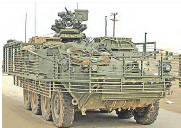
БТР М1126 с комплектом решетчатой защиты от РПГ
